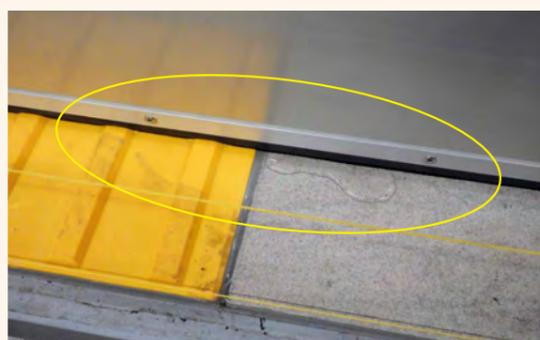
3回の実測漏水量平均が240ml/分の漏水しか見られませんでした。これは、評価ランクにおけるWs-4相当となります。
