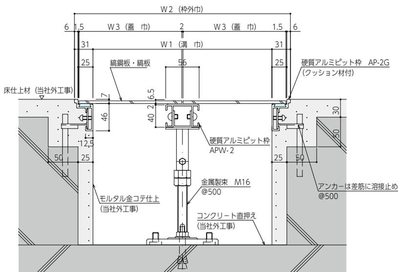
縞鋼板用 一般工場、ビルの電気室、発電機室などに…
