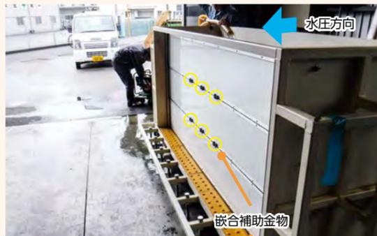
嵌合補助金物（特許出願済）により、パネルのたわみが従来製品比30%抑制されました。
