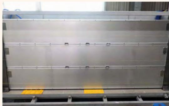
敢えて点字ブロック上にパネルが接するようにセットし、幅2,400mm、高さ1,050mmの水槽に水を溜め、漏水量を測定。
