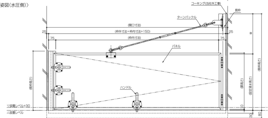
〈断面図(防水板解除時)〉
